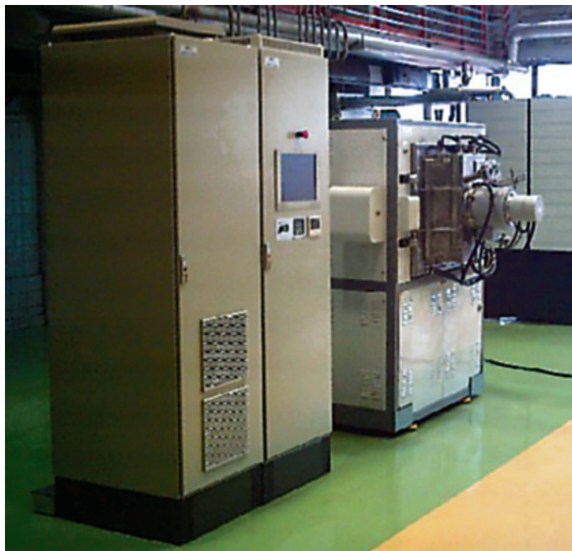
Серийная установка «Станкин-АПП-1» для вакуумно-плазменного поверхностного упрочнения инструмента и деталей, внедренная в ОАО «АВТОВАЗ»
