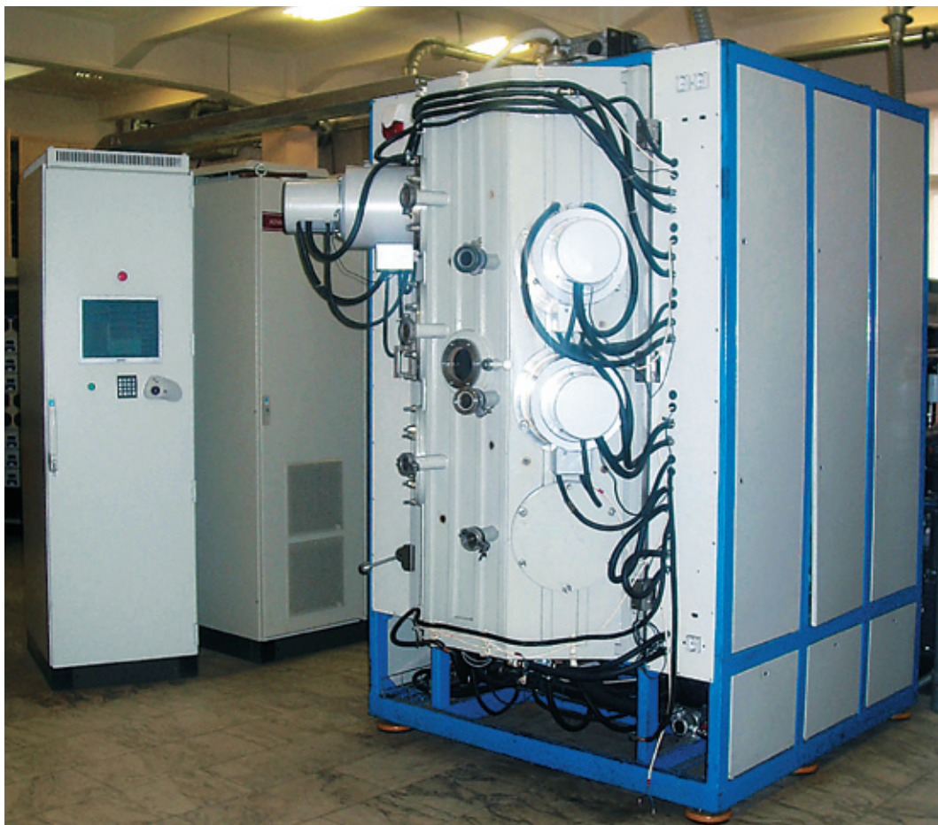
Серийная установка «Станкин-АПП-2» для вакуумно-плазменного упрочнения длинномерных изделий, внедренная на ФГУП «НПЦ газотурбостроения «САЛЮТ»
