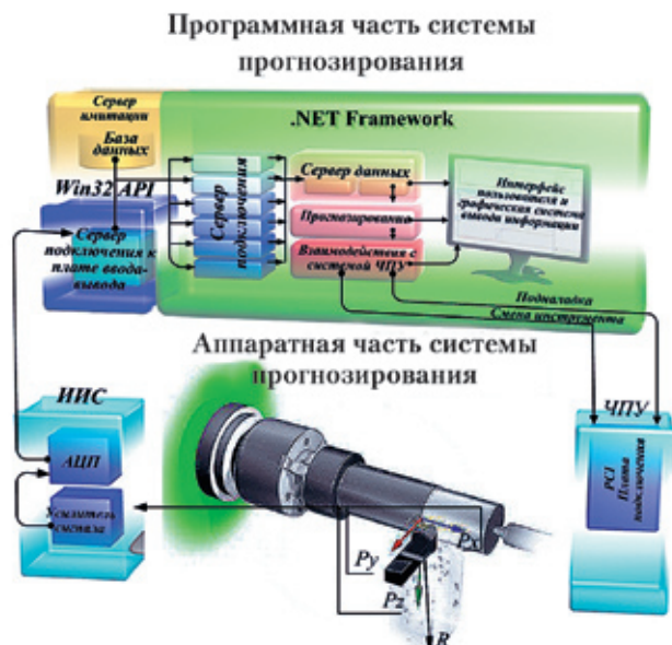
Структура системы диагностирования токарных резцов и прогнозирования их остаточной стойкости
